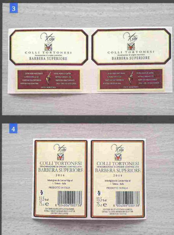
1) I vigneti di Cantine Volpi. 2) Le bottiglie pronte per l'etichettatura. 3) Il frontale di un'etichetta stampato presso un etichettificio esterno. 4) Il retro della stessa etichetta realizzato con l'unità Epson ColorWorks C7500 installata in azienda.
